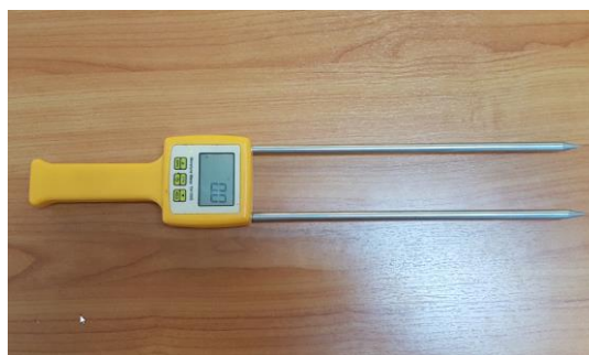
รูปที่ 4-15 เครื่องวัด % ความชื้น Moisture Meter TK00S
