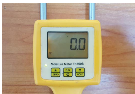
รูปที่ 4-16 เครื่องวัด % ความชื้น Moisture Meter TK00S
