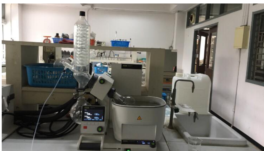
รูปที่ ผน5 การระเหยตัวทำละลายออกจากไขมันที่สกัดได้
