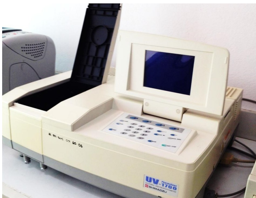
ภาพที่ ข4 เครื่องวัดการดูดกลืนแสง (UV-VIS Spectrophotometer, ยี่ห้อ SHIMADZU, รุ่น UV-1700)
