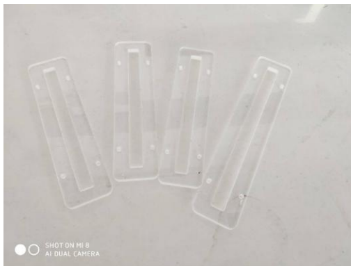
รูปที่ 3.8 แผ่นอะคลีลิกที่ตัดด้วยเครื่อง CNC แล้ว
