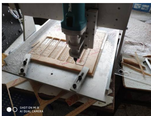
รูปที่ 3.7 สั่งเครื่อง CNC ด้วยโปรแกรม Mach 3
