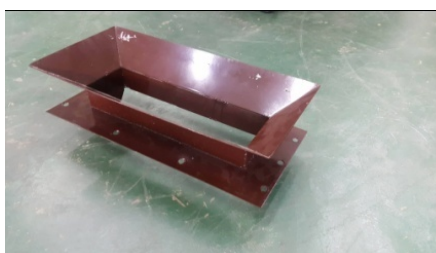
รูปที่ 3-11 รูปถ่ายช่องป้อนไบตะไคร้
