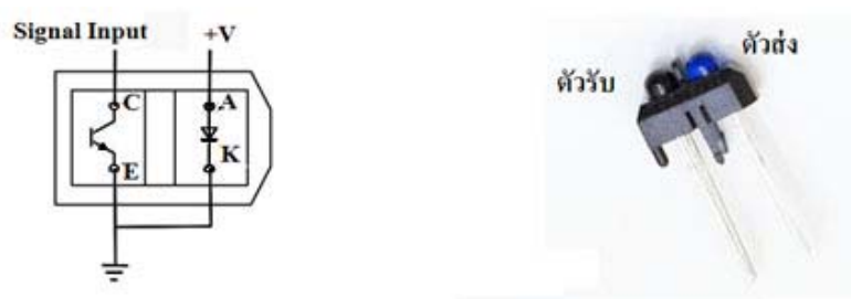
(ก) โครงสร้างภายในเซนเซอร์ชนิดใช้แสง (ข) ตัวอย่างอุปกรณ์เซนเซอร์ชนิดใช้แสง
