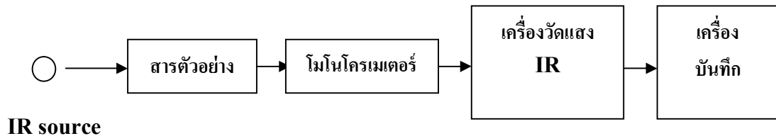
รูปที่ 2.6 แสดงแผนผังองค์ประกอบของเครื่องอินฟราเรดสเปกโทรโฟโตมิเตอร์
