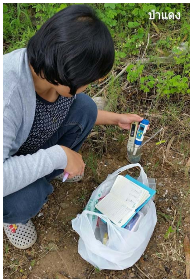
ภาพที่ ค-4 การวัดค่า pH DO และอุณหภูมิของน้ำ
