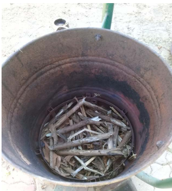
รูปที่ 3-10 ใส่เชื้อก่อไฟสำหรับเผาถ่าน
