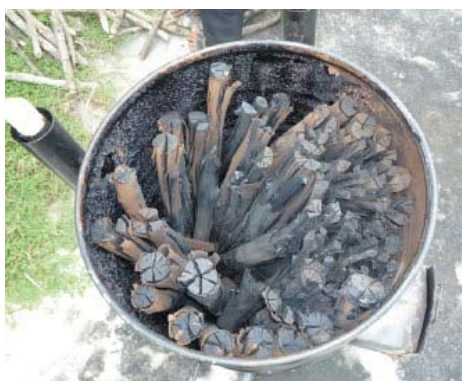
รูปที่ 2-15 การใส่ไม้สำหรับเผาถ่านไม้จากถังน้ำมัน 200 ลิตร (ที่มา : ไร่ชญาทิพ, 26 ตุลาคม 2561)
