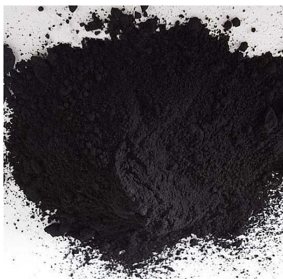
รูปที่ 3-16 ผงถ่านไม้ไผ่ที่ผ่านการบดด้วยเครื่องบด
