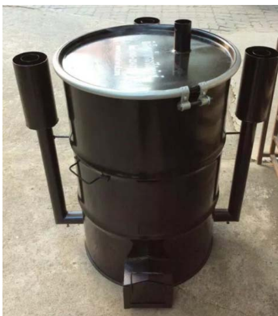
รูปที่ 2-13 เตาเผาถ่านไม้ผลิตจากถ่านน้ำมัน 200 ลิตร
