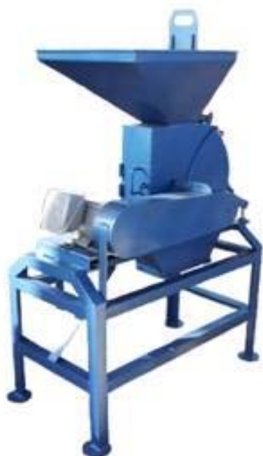
รูปที่ 2-16 ชุดบดถ่านสำหรับการผลิตถ่านอัดแท่ง (ที่มา : หจก. ชญาเมชชีนเนอรี่, 2 ตุลาคม 2561)
