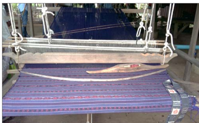
รูปภาพที่ 4.52 กี่ ฟืม และกระสวย แบบดั้งเดิมที่กลุ่มทอผ้าฝ้ายบ้านตัวใช้ทอผ้า
