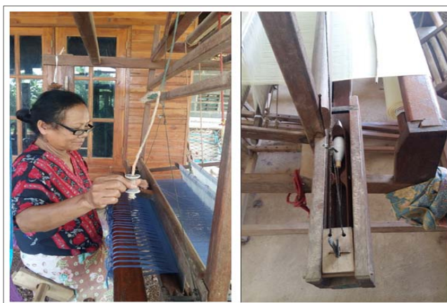
รูปภาพที่ 4.36 การกระตุกผ้าขณะทอ และรางวิ่งกระสวยของก๊กระตุก กลุ่มทอผ้าที่กระตุกบ้านวังร่อง
