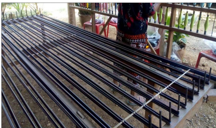
รูปภาพที่ 4.39 หลักเฟือกกลุ่มทอผ้าที่กระตุกบ้านวังร่องซึ่งเป็นหลักแบบสมัยใหม่
