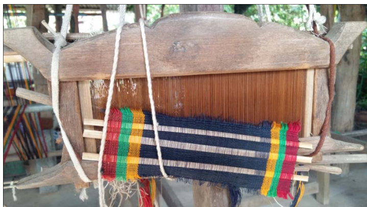
รูปภาพที่ 4.54 พิมพ์แบบดั้งเดิมที่พื้นหวีทำจากไม้ กลุ่มทอผ้าฝ้ายบ้านตัวใช้ทอถุงย่าม
