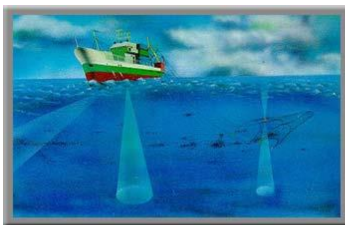
ภาพที่ 2.4 การหาความลึกของน้ำทะเลด้วยเครื่องโซนาร์ 2
