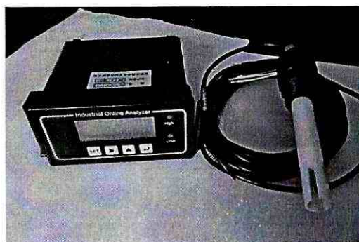
ภาพที่ 2.12 มิเตอร์วัดค่า EC ในน้ำ
