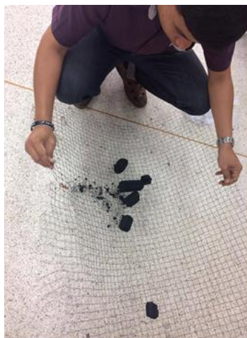
รูปที่ 3.21 แสดงการร้อนถ่านอัดแท่งจากเปลือกมะขามด้วยตะแกรงขนาด 20 มิลลิเมตร
