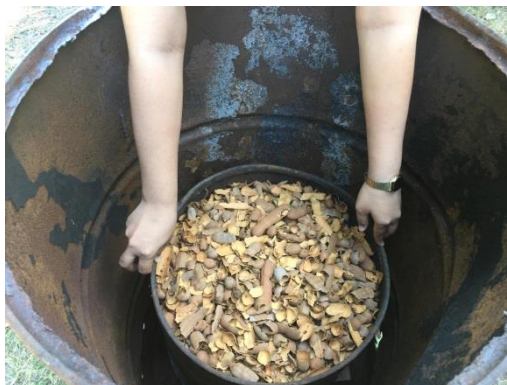
รูปที่ 3.2 แสดงลักษณะของการวางถังขนาดเล็กลงไปในถังขนาดใหญ่ แล้วบรรจุเปลือกมะขามลงไปจนถึงเล็ก
