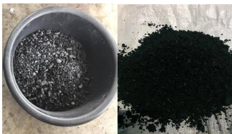
รูปที่ 3.7 แสดงลักษณะของถ่านเปลือกมะขามที่ผ่านบดหยาบและบดละเอียด
