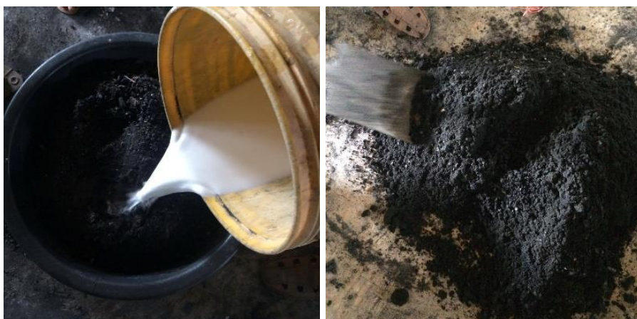
รูปที่ 3.9 แสดงขั้นตอนการผสมวัตถุดิบสำหรับผลิตถ่านอัดแท่งจากเปลือกมะขาม
