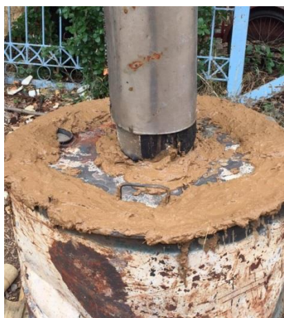
รูปที่ 3.5 แสดงการใช้ดินเหนียวอุดบริเวณฝาเตาเพื่อป้องกันอากาศเข้าสู่เตา
