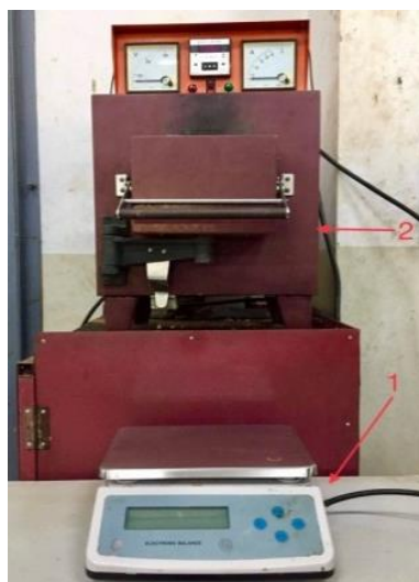
รูปที่ 3.13 แสดงเครื่องมือที่ใช้ในการทดสอบปริมาณความชื้นของถ่านอัดแท่งจากเปลือก
