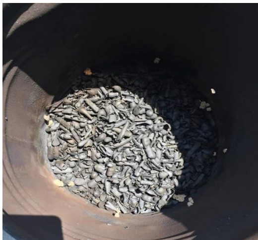
รูปที่ 3.6 แสดงลักษณะของถ่านเปลือกมะขามที่ผ่านการเผาเรียบร้อยแล้ว
