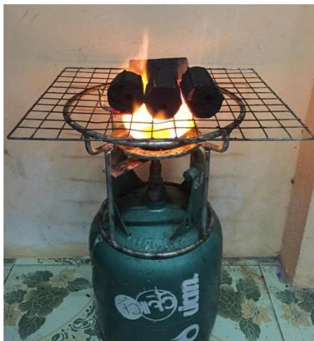
รูปที่ 3.24 แสดงการนำถ่านอัดแท่งไปเผาไฟด้วยเตาแก๊ส
