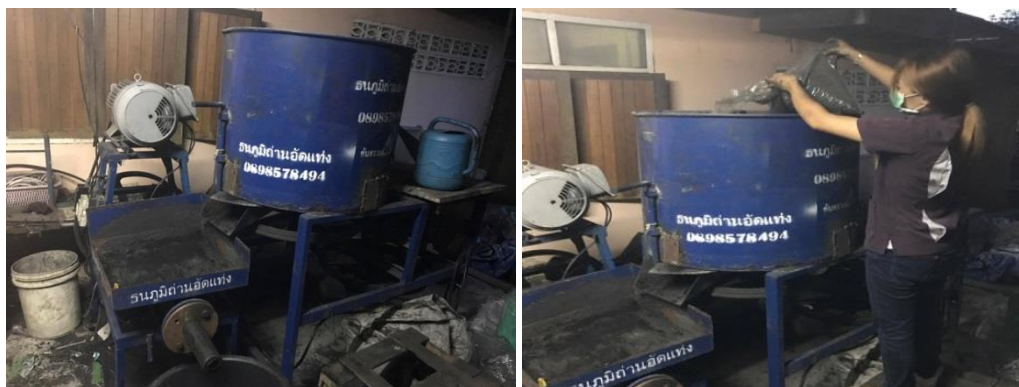
รูปที่ 3.10 แสดงขั้นตอนเทวัตถุดิบลงในถังผสมของเครื่องอัดแท่งแบบสกรูเดี่ยว
