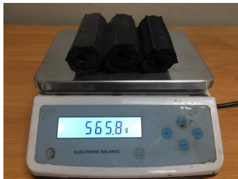
รูปที่ 3.16 แสดงการนำตัวอย่างไปชั่งน้ำหนัก ( W_2 ) หลังผ่านการอบ
