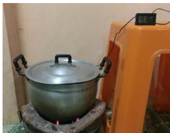
รูปที่ 3.26 แสดงการวัดอุณหภูมิของน้ำภายในหม้อต้มน้ำ
