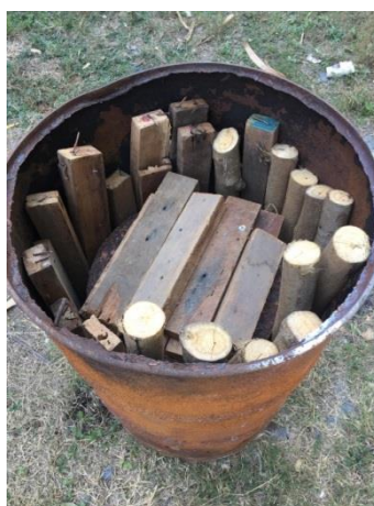
รูปที่ 3.3 แสดงลักษณะของการจัดเรียงไม้เชื้อเพลิงลงไปในถังใหญ่
