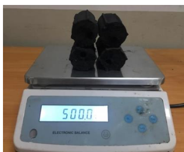
รูปที่ 3.22 แสดงการชั่งน้ำหนักถ่านอัดแท่งก่อนการทดสอบประสิทธิภาพการใช้งานของความร้อน
