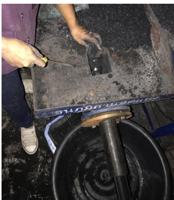
รูปที่ 3.11 แสดงขั้นตอนการอัดแท่งถ่านจากเปลือกมะขาม
