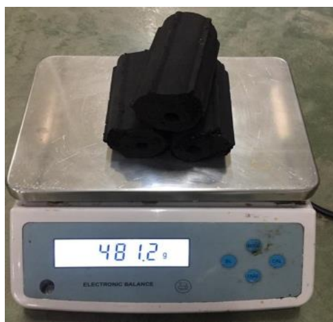
รูปที่ 3.17 แสดงการนำตัวอย่างมาชั่งน้ำหนักก่อนทดสอบการแตกร้าวโดยวิธีทิ้งจากที่สูง
