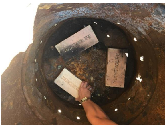
รูปที่ 3.1 แสดงขั้นตอนการนำอิฐแดงวางกันถึง 200 ลิตร
