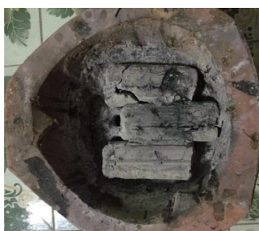
รูปที่ 3.26 แสดงลักษณะถ่านอัดแท่งเมื่อสิ้นสุดการทดสอบประสิทธิภาพการใช้งานของความร้อน
