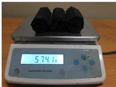
รูปที่ 3.14 แสดงการนำตัวอย่างมาชั่งน้ำหนัก ( W_1 ) ก่อนอบ
