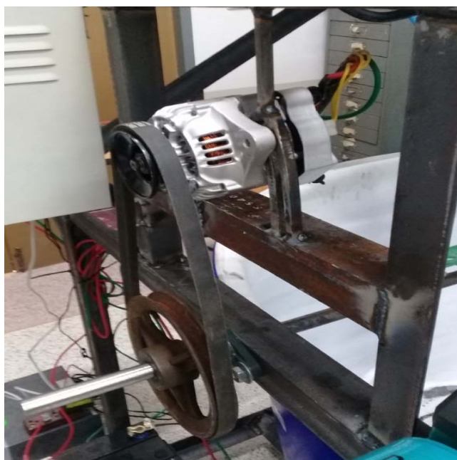
รูปที่ 3-4 เจนเนอเรเตอร์ 12 โวลท์ 10 แอมแปร์และพวเลซ์ส่งกำลัง
