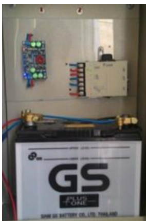
รูปที่ 4.5 แสดงวงจรประจุพลังงานไฟฟ้า
