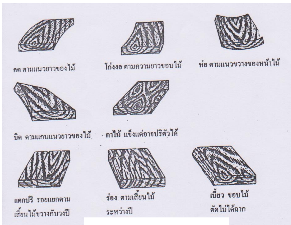
ภาพที่ 2.9 แสดงการบิดตัวและหดตัวของเนื้อไม้
