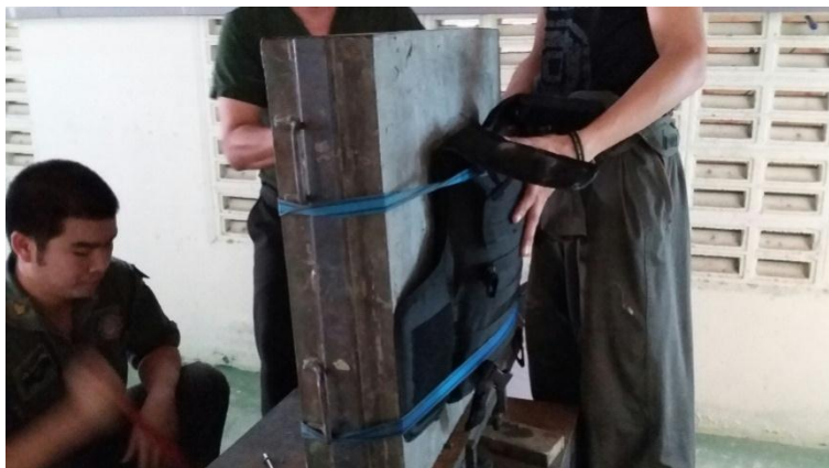
รูปที่ 4-13ติดตั้งเสื้อเกราะกันกระสุนกับชุดทดสอบ
