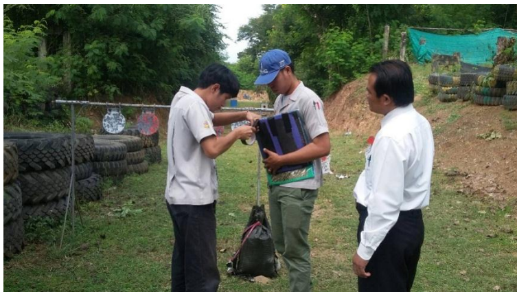
รูปที่ 4-1 ติดตั้งเสื้อเกราะกันกระสุนกับชุดทดสอบ
