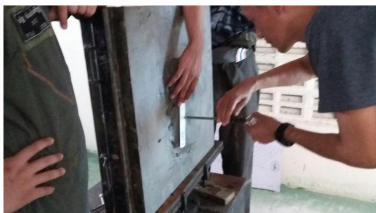
รูปที่ ก-14 การตรวจวัดค่าการยุบตัว
