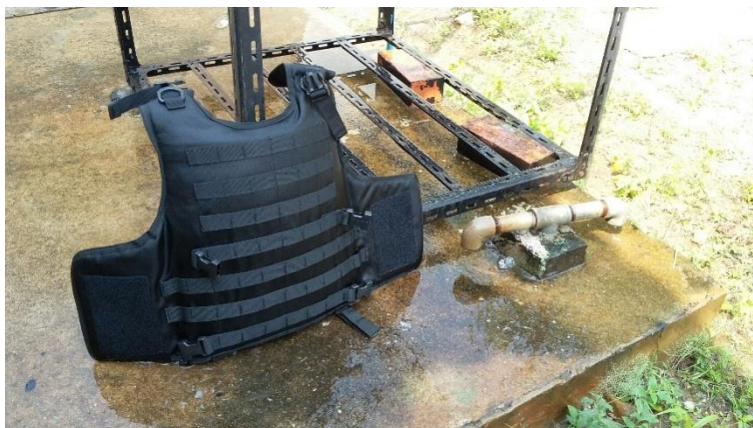
รูปที่ 4-11 นำเสื้อเกราะกันกระสุนไปพรมด้วยน้ำ
