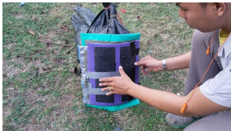
รูปที่ ก-2 การจัดเตรียมเสื้อเกราะกันกระสุนและตำแหน่งการวางเพื่อยิงทดสอบ
