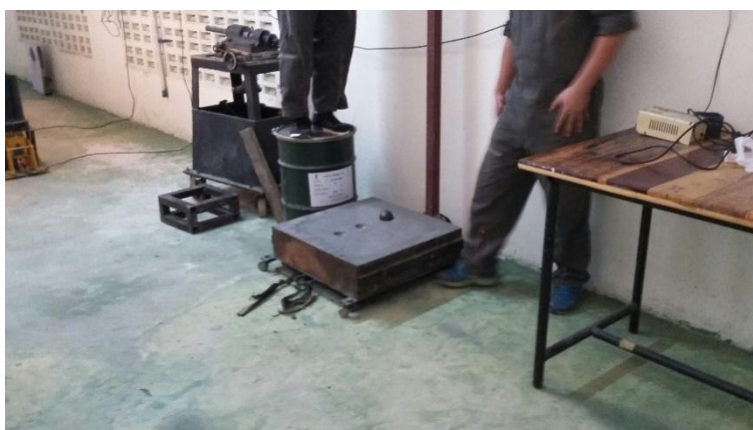
รูปที่ 4-12 ทดสอบค่าการยุบตัวของดินสังเคราะห์
