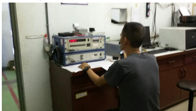
รูปที่ ก-12 การเตรียมชุดวัดความเร็วกระสุน
