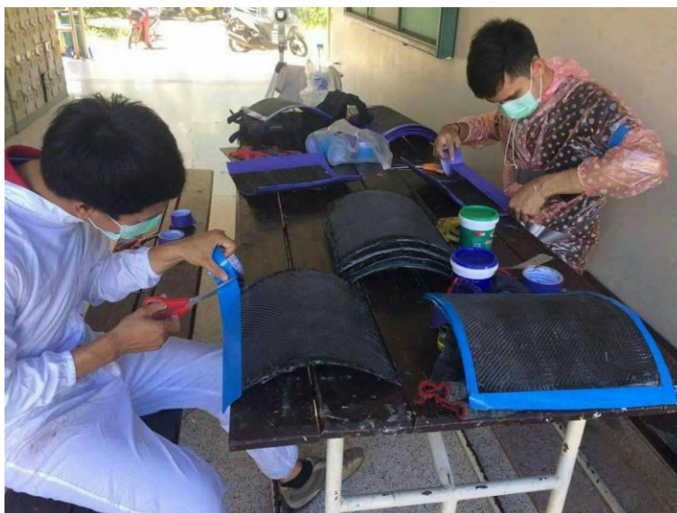
รูปที่ ข-4 แผ่นเกราะกันกระสุนสำเร็จ
