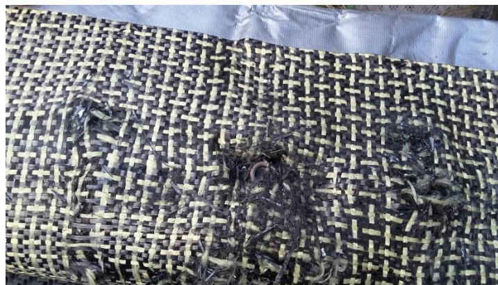
รูปที่ ก-5 การตรวจสอบตำแหน่งที่ทำการยิงทดสอบ
