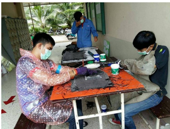
รูปที่ ข-3 การทากาวอีพ็อกซีพัตต์ลงบนแผ่นเกราะกันกระสุนให้ทั่วแผ่น
