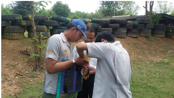
รูปที่ ก-7 การตรวจสอบลักษณะทางกายภาพของเสื้อเกราะกันกระสุนหลังยิงทดสอบ
