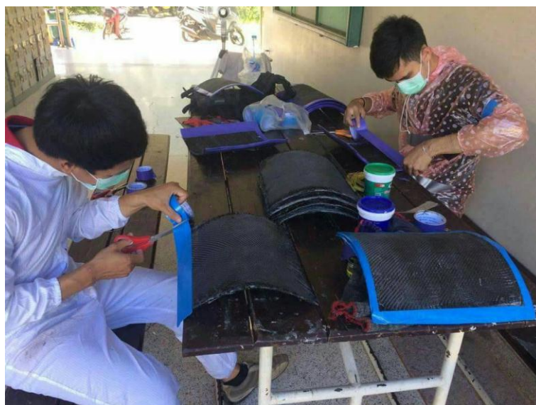
รูปที่ 4-17 การจัดทำเสื้อเกราะกันกระสุน
