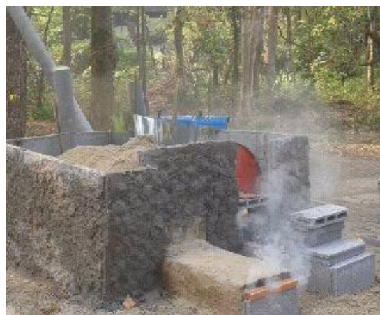
รูปที่ 4.3 แสดงเตาเผาถ่านแบบแนวนอนและท่อเก็บน้ำส้มควันไม้ ที่ใช้ในการผลิตน้ำส้มควันไม้
