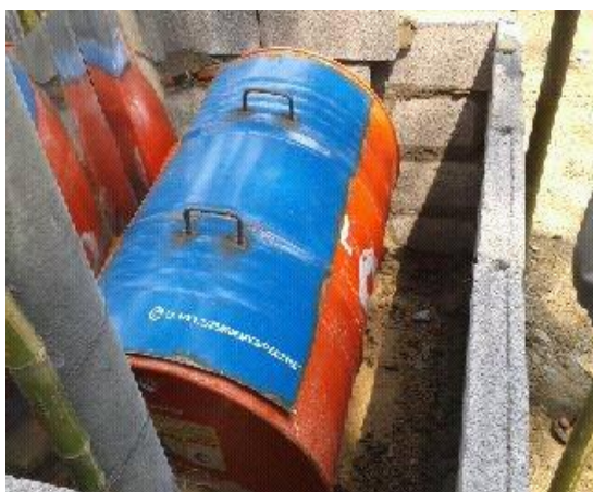
รูปที่ 4.3 แสดงเตาเผาถ่านแบบแนวนอนและท่อเก็บน้ำส้มควันไม้ ที่ใช้ในการผลิตน้ำส้มควันไม้
