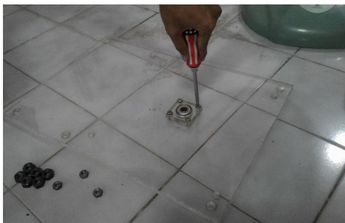
รูปที่ 4.6 ประกอบลูกปืนเข้ากับแท่นยึด
