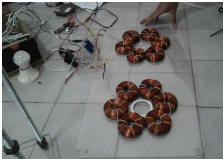
รูปที่ 4.5 การประกอบขดลวดเข้ากับแผ่นอะคริลิก
