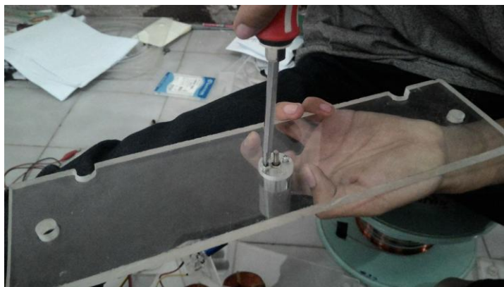
รูปที่ 4.8 ประกอบมอเตอร์เข้ากับแท่นยึด
