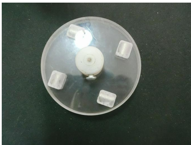
รูปที่ 4.3 ตัดแผ่นอะคลิลิกสำหรับติดแกนมอเตอร์
