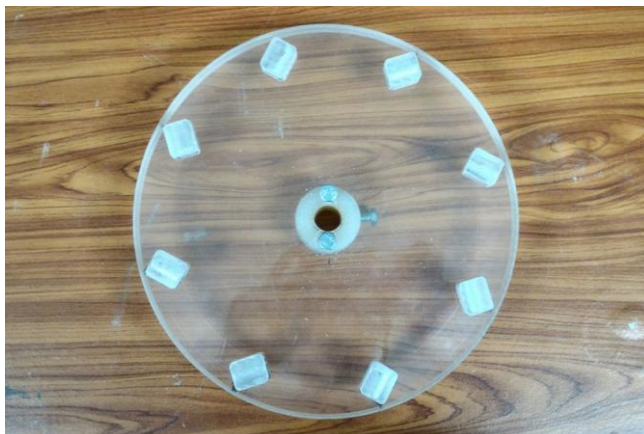
รูปที่ 4.2 ตัดแผ่นอะคลิลิกสำหรับติดแกนหมุนสร้างสนามแม่เหล็ก
