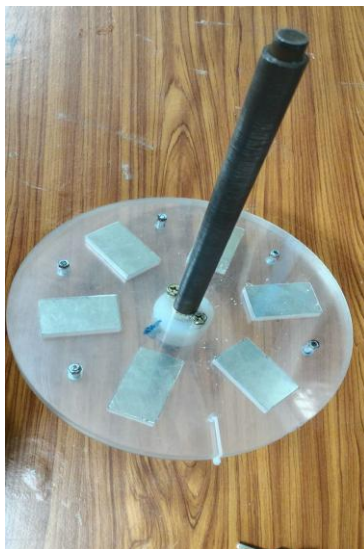
รูปที่ 4.7 ประกอบแผ่นอะคลิลิกสำหรับวิ่งผ่านขดลวดเข้ากับแกนเพลลา
