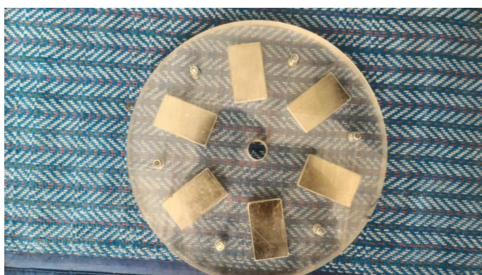
รูปที่ 4.4 ตัดแผ่นอะคลิลิกสำหรับสร้างสนามแม่เหล็ก
