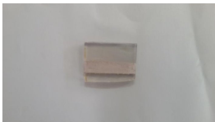
ภาพที่ 3-5 แสดง ก) กระจกนำไฟฟ้าที่เคลือบด้วยไททาเนียมไดออกไซด์ ข) กระจกนำไฟฟ้าที่แช่ด้วยสารสกัดข้าวเหนียวลิ้มฟัว และ ค) ขั้วลบ (Working electrode)
