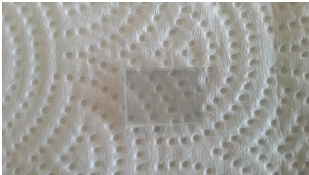
ภาพที่ 3-4 แสดงกระจกนำไฟฟ้า (กระจก FTO) ที่ตัดแล้ว
