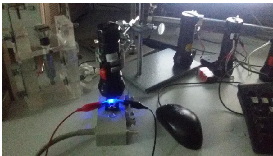
ภาพที่ 3-9 แสดงการวัดการเปลี่ยนแปลงการนำไฟฟ้าของเซลล์แสงอาทิตย์ชนิดสีย้อมไวแสง
