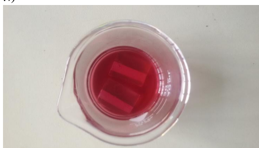
ภาพที่ 1-1 ก) แสดงสีย้อมและขั้วลบที่เชื่อมอยู่ในสีย้อมไวแสงที่ได้จากข้าวเหนียวลิ้มผ้าว และ ข) เซลล์แสงอาทิตย์ชนิดสีย้อมไวแสงโดยใช้สารสกัดของข้าวเหนียวลิ้มผ้าว
