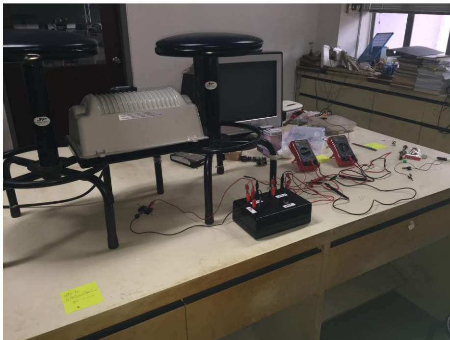
ภาพที่ 3-10 แสดงเครื่องวัดกราฟกระแสไฟฟ้า-ศักย์ไฟฟ้า (I-V curve) จากแสงอาทิตย์จำลอง
