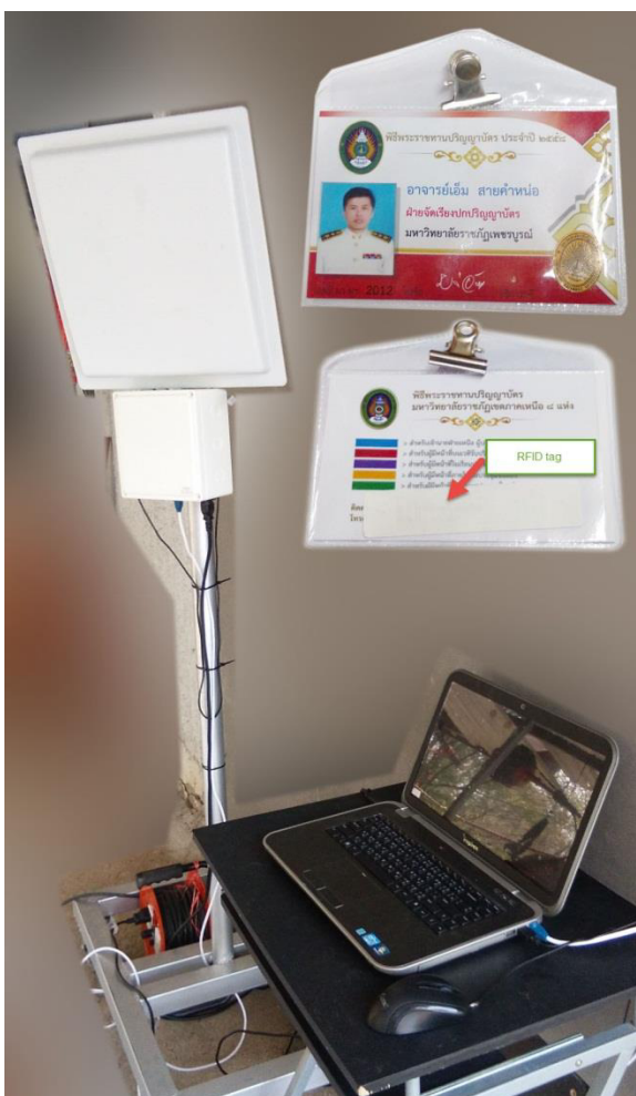
รูปที่ 1 แสดงการติดตั้งอุปกรณ์และการติดแท็กในบัตร
