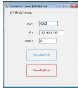
ภาพที่ 4 แสดงการกำหนดช่องทาง (Port) ให้กับอุปกรณ์
