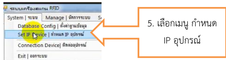
รูปที่ 5 แสดงการเข้าถึงวิธีการกำหนด IP อุปกรณ์
