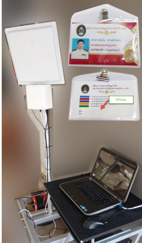
รูปที่ 3.9 แสดงการติดตั้งอุปกรณ์และการติดแท็กในบัตร
