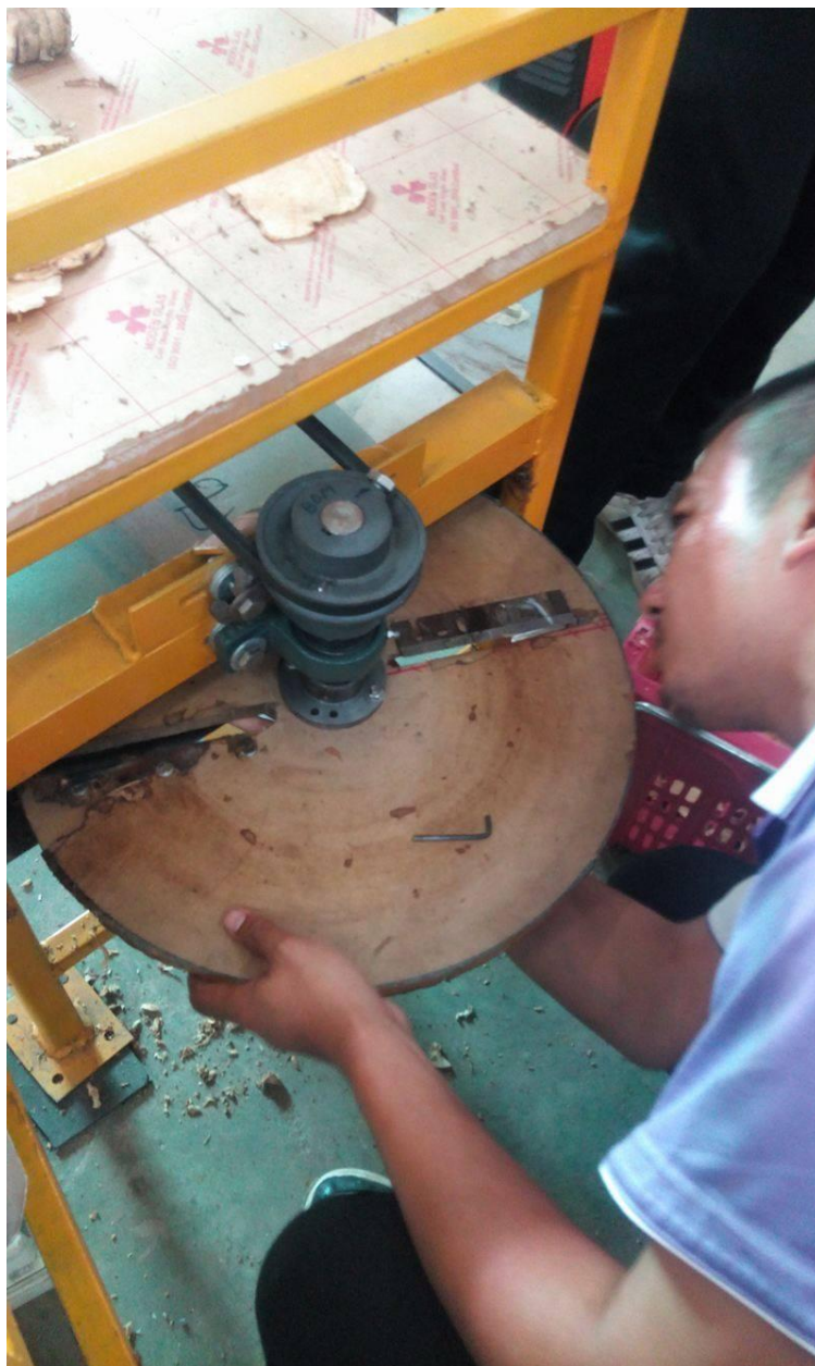
รูปที่ ข-3 โครงสร้างเครื่องหันสมุนไพรร่วนชักมดลูกส่วนใบมีด
