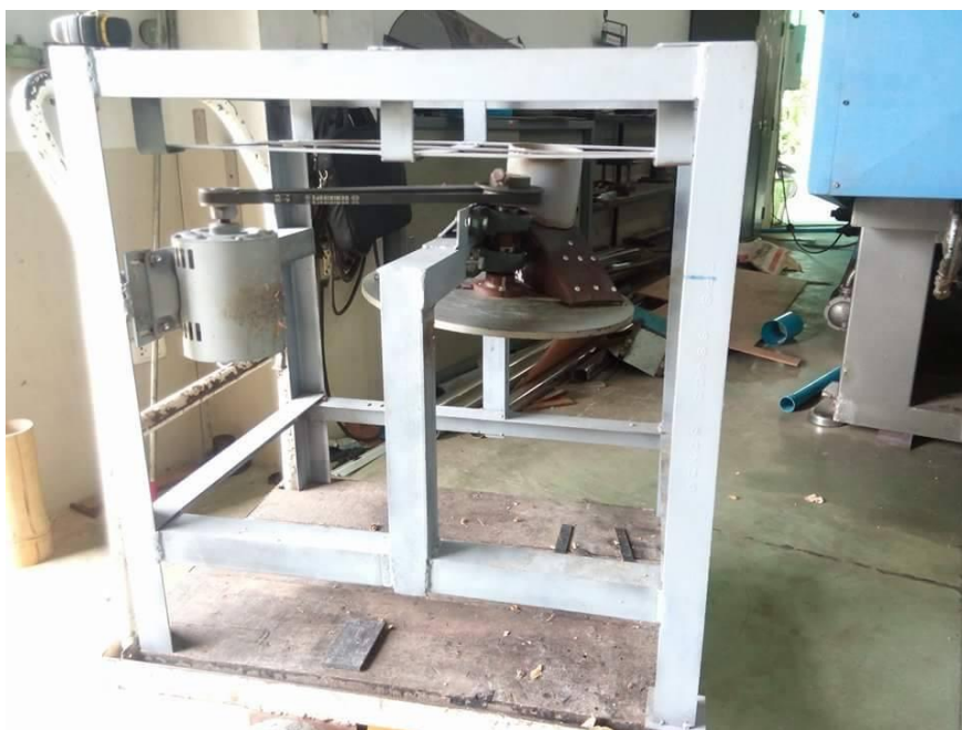
รูปที่ ข-2 โครงสร้างเครื่องหันสมุนไพรวานชักมดลูกด้าน 2
