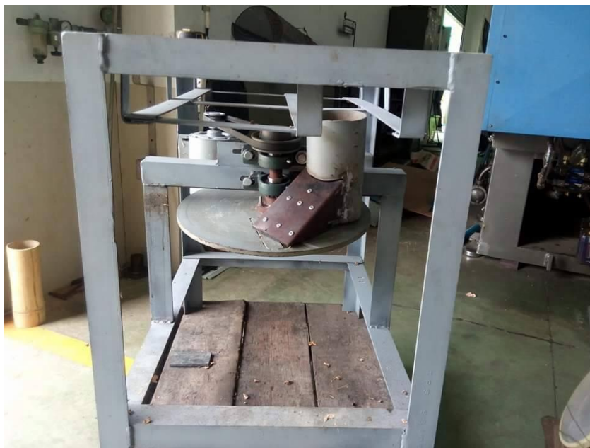
รูปที่ ข-1 โครงสร้างเครื่องหันสมุนไพรวานชักมดลูกด้าน 1
