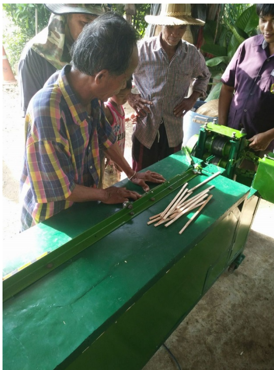
รูปที่ ก-3 ชาวบ้านทำการใช้งานเครื่องผ่าไม้ไผ่ไถ่อย่าง
