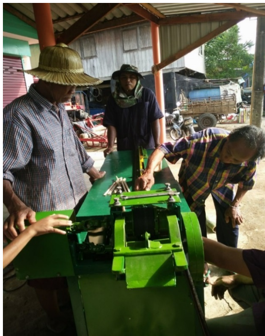
รูปที่ ก – 1 การทดสอบเครื่องผ่าไม้ไผ่ไถ่อย่าง
