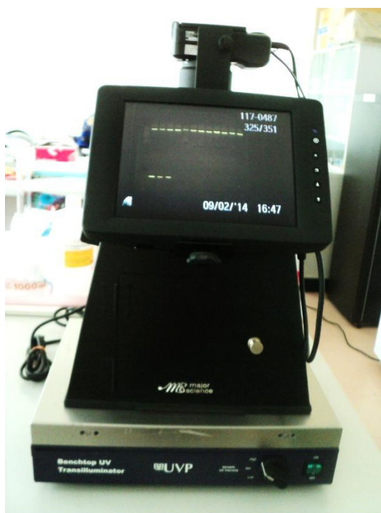
ภาพที่ ผ2 ชุดเครื่องถ่ายภาพดีเอ็นเอ (UV Transilluminator, ยี่ห้อ UVP, รุ่น LLC Upland, cambridge, UK)
