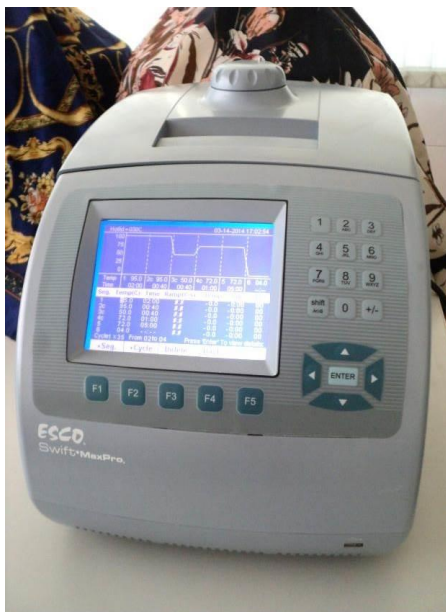
ภาพที่ ผ1 เครื่องควบคุมปฏิกิริยาพีซีอาร์ (Swift™ MaxPro Thermal Cycler)
