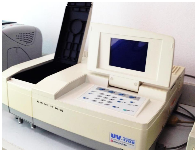
ภาพที่ ผ4 เครื่องวัดการดูดกลืนแสง (UV-VIS Spectrophotometer, ยี่ห้อ SHIMADZU, รุ่น UV-1700)
