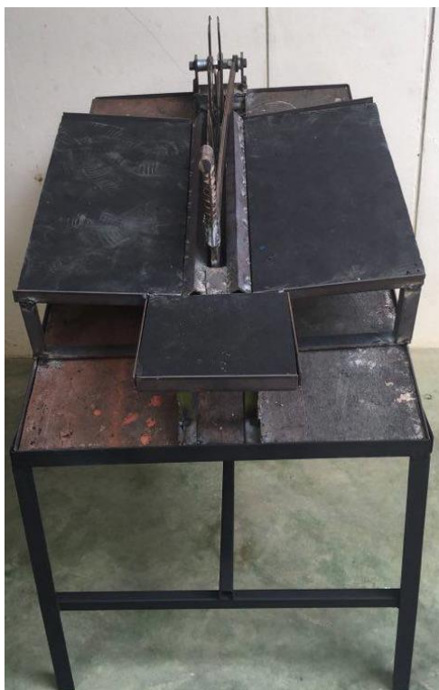
ภาพที่ 4.4 ภาพถ่ายด้านหน้าเครื่องฉีกก้านใบยาที่แบบปรับปรุงตามหลักการยศาสตร์
