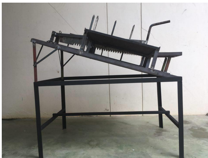
ภาพที่ 4.3 ภาพถ่ายด้านข้างเครื่องฉีกก้านใบยาที่แบบปรับปรุงตามหลักการยศาสตร์
