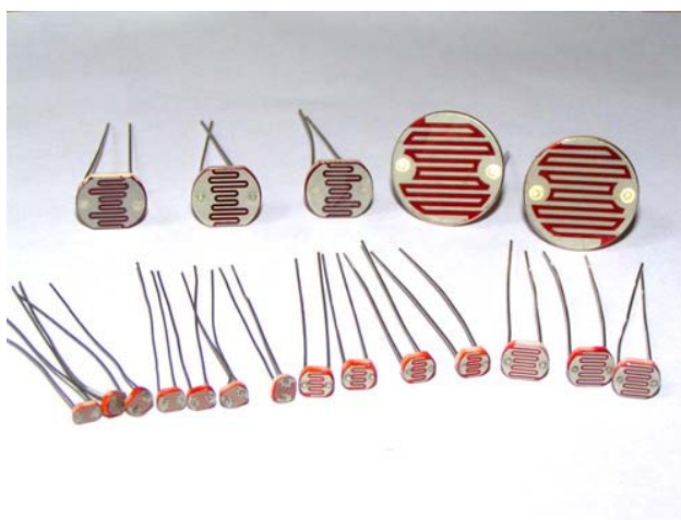
รูปที่ 2-27 ตัวอย่างตัวเซนเซอร์แสง LDR (ที่มา : สนธยา นงนุช. 11 ธันวาคม 2559)
