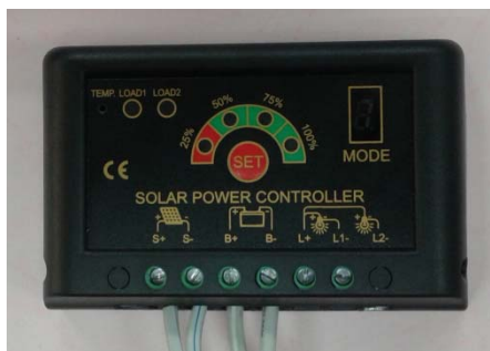
รูปที่ 3-10 ชุดประจุไฟฟ้า 12/24 โวลต์
