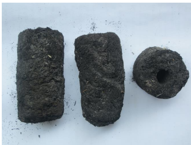
รูปที่ 4.8 แสดงลักษณะทางกายภาพและสัณฐานวิทยาของเชื้อเพลิงชีวมวลอัดแท่งที่ผ่านการเผาให้กลายเป็นถ่าน
