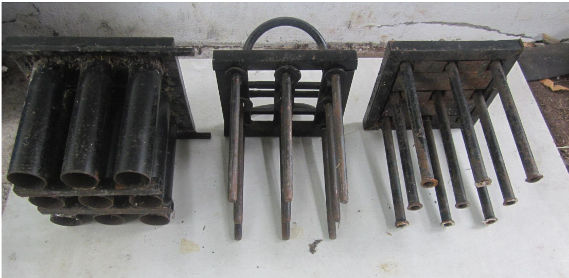
รูปที่ 4.5 แสดงลักษณะปั้งอัดแห่งฉะมวณด้วยมืออย่างง่ายที่ประดิษฐ์ขึ้นเพื่อใช้ในการศึกษา (แบบกลวง)
