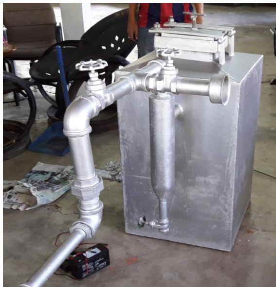
รูปที่ 4.12 แสดงของเตาเผาแก๊สซิไฟเออร์แบบ up draft ที่ใช้ในการศึกษาประสิทธิภาพ
