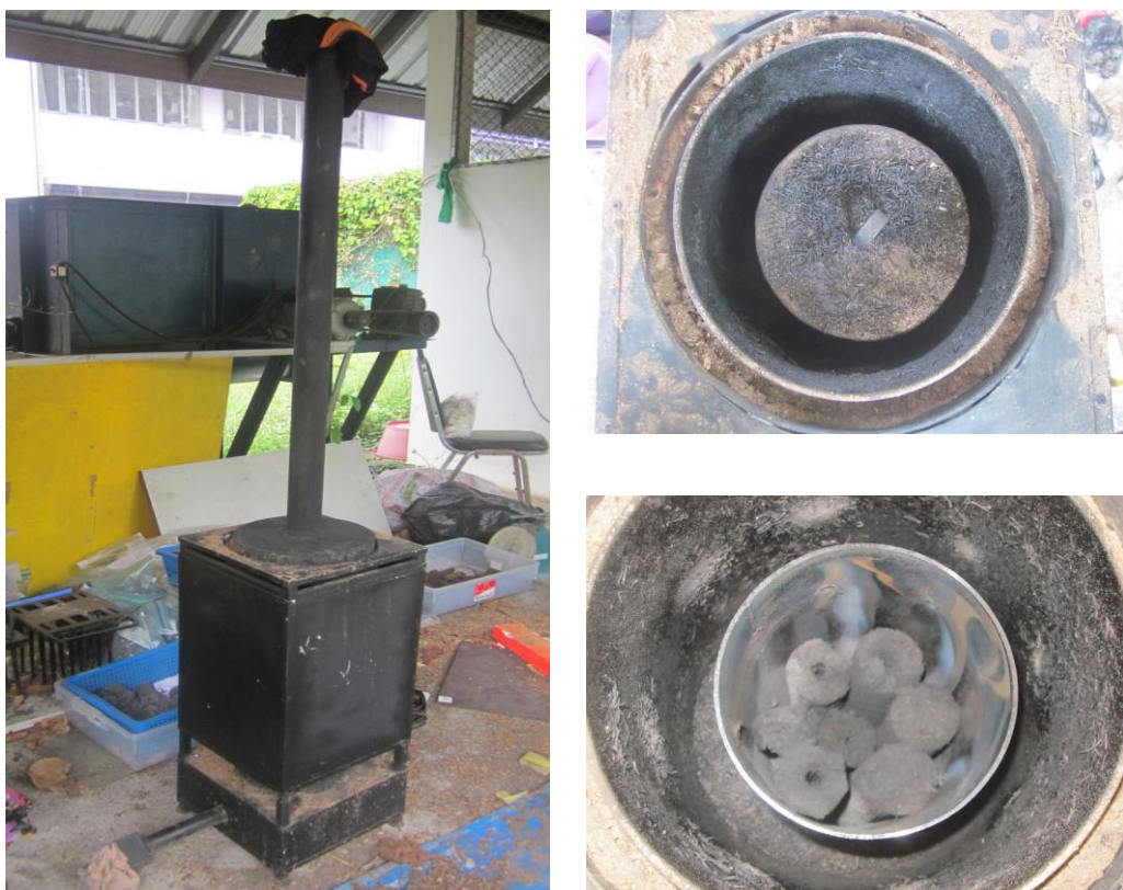
รูปที่ 4.7 แสดงชุดอุปกรณ์ในการเผาแท่งเชื้อเพลิงชีวมวลให้เป็นถ่าน
