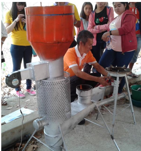
รูปที่ 4.13 แสดงของเตาเผาแก๊สซิไฟเออร์แบบ down draft ที่ใช้ในการศึกษาประสิทธิภาพ
