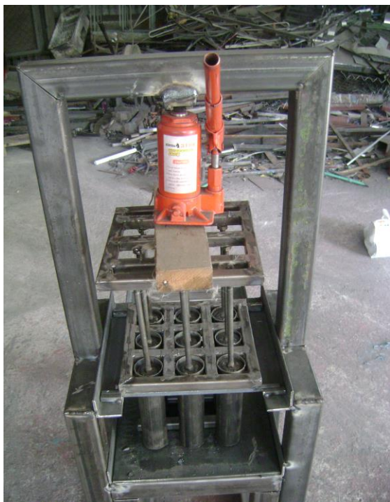
รูปที่ 4.2 แสดงลักษณะเครื่องอัดแท่งชีวมวลด้วยมืออย่างง่ายที่ประดิษฐ์ขึ้นเพื่อใช้ในการศึกษา
