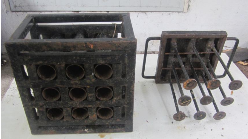
รูปที่ 4.4 แสดงลักษณะปั้งอัดแห่งฉะมวณด้วยมืออย่างง่ายที่ประดิษฐ์ขึ้นเพื่อใช้ในการศึกษา (แบบต้น)
