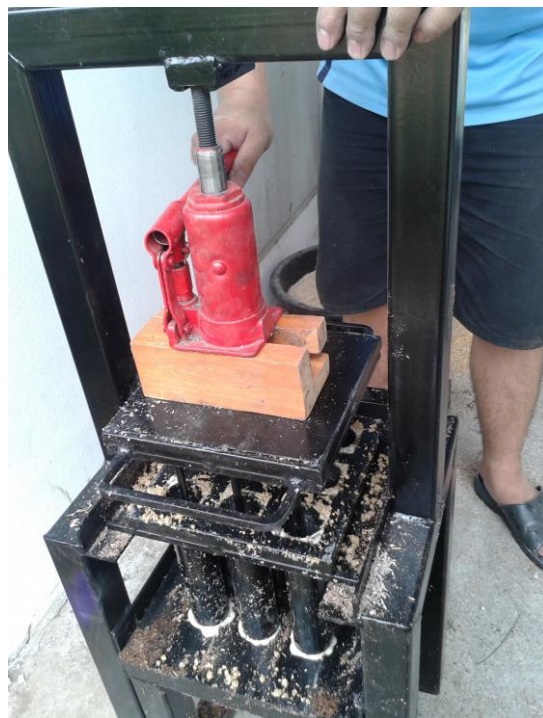
รูปที่ 4.2 แสดงลักษณะเครื่องอัดแท่งชีวมวลด้วยมืออย่างง่ายที่ประดิษฐ์ขึ้นเพื่อใช้ในการศึกษา
