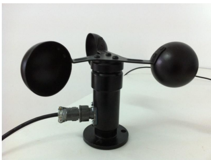
รูปที่ 3-2 ชุดเซ็นเซอร์ตัววัดความเร็วลมจะเป็นแบบสามก้าน
