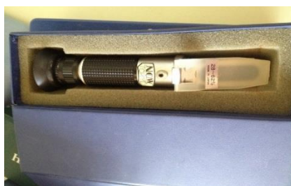
ภาพที่ ผก 5 แสดงเครื่องวัด Hand refractometer ยี่ห้อ ATAGO® PAL-1 (N 10-32)
