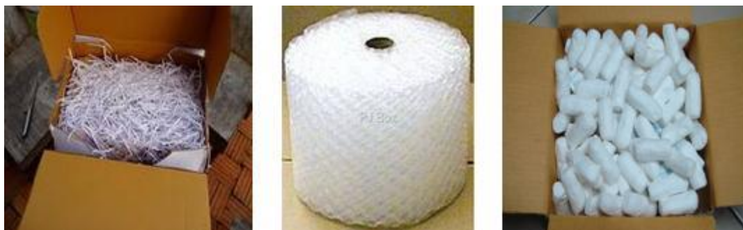
รูปที่ 2.7 ตัวอย่างวัสดุป้องกันการสั่นกระแทกโดยมีลักษณะเป็นกระดาษที่ข่อยเป็นเศษ
