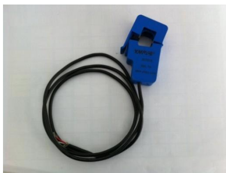
ภาพที่3-2 หม้อแปลงกระแสขนาด 30A/1V ที่ใช้ในการวิจัย
