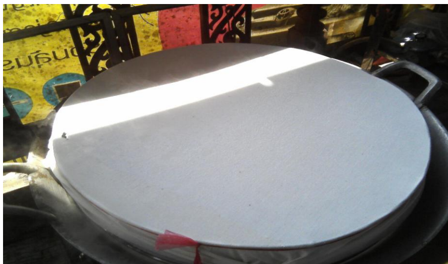
ภาพที่ 4.18 วงกลมสังกะสีที่นำผ้าขาวบางมามัดจึงเป็นสะดึงวางไว้บนกระทะใส่น้ำต้มเดือดจัด
