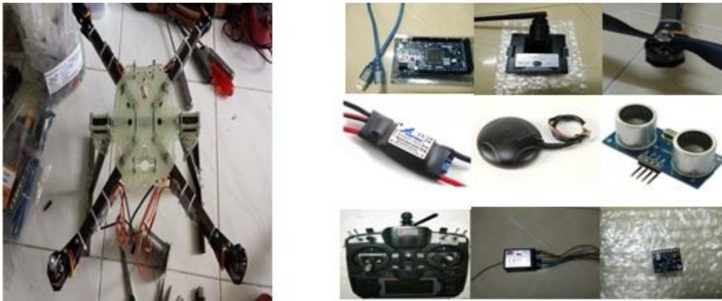
รูปที่ 2. วัสดุอุปกรณ์ในการสร้างโดรนขนาด450
